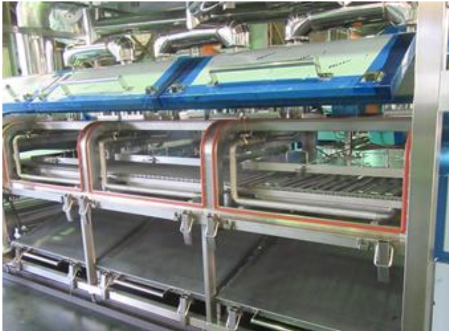
1段式ゾーンタイプ 装置庫内
